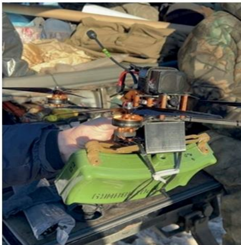
6. számú ábra: Kvadrokopterre szerelt MON-50 irányított repeszakna 12
