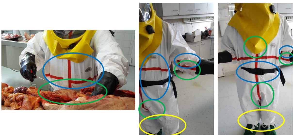
8. sz. ábra: A fröccsenéssel (kék), kenődéssel (zöld) és lecsöppenéssel (sárga) létrejövő szennyeződési mintázatok (Dr. Babinszky Gergely felvételei)
