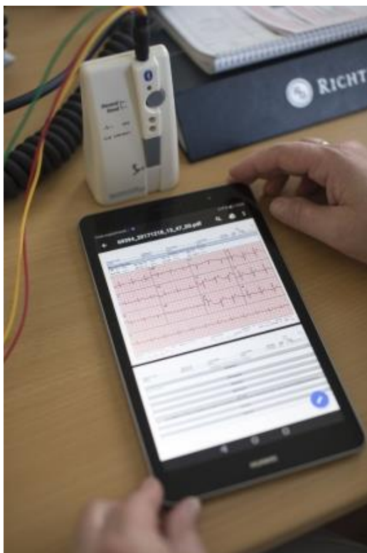
11. számú ábra: TTEKG által készített EKG felvétel az Intelligens fedélzeti terminál felületén
