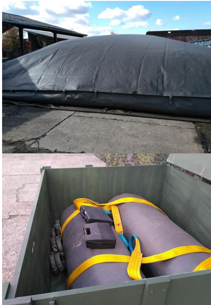
18. kép: 300m 3 ellasztikus üzemanyag tartály (forrás: HM Elektronikus Ügyintézési Portál) 394
