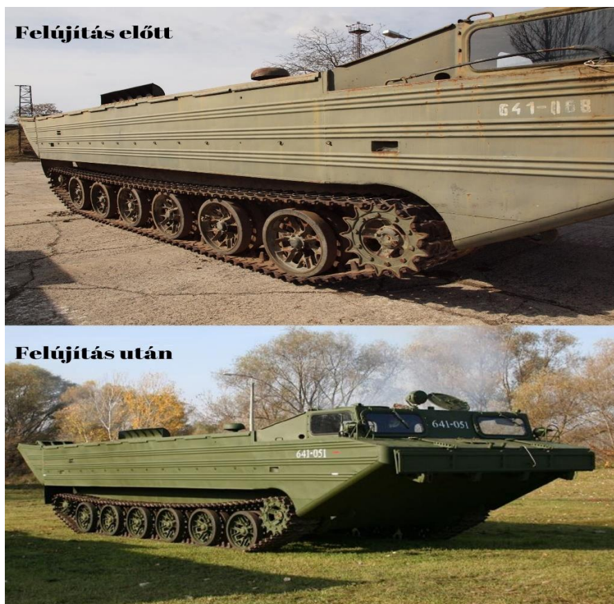
13. kép: PTSZ-M közepes lánc talpas úszó gépkocsi felújítás előtti és utáni állapota (forrás: HM Elektronikus Ügyintézési Portál) 389
