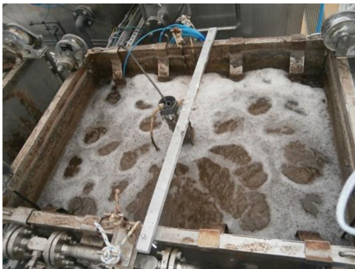
4.15. ábra: A fixfilmes félüzemi kaszkád egyik eleme (saját szerkesztés [69] alapján)
