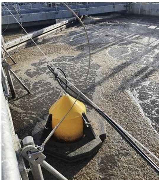
4.2. ábra: Az off-gas tesztelésben használt gázgyűjtő búra a medence felszínén [140]
