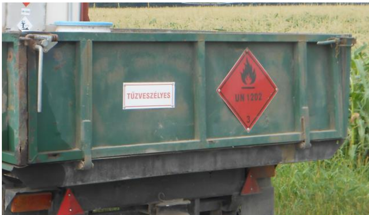
15. kép. Pótkocsi hátuljának megjelölése 1 m 3 gázolaj szállítására esetén. Az UN-számmal ellátott nagybárca elhelyezése nem kötelező. Forrás: saját fénykép.
