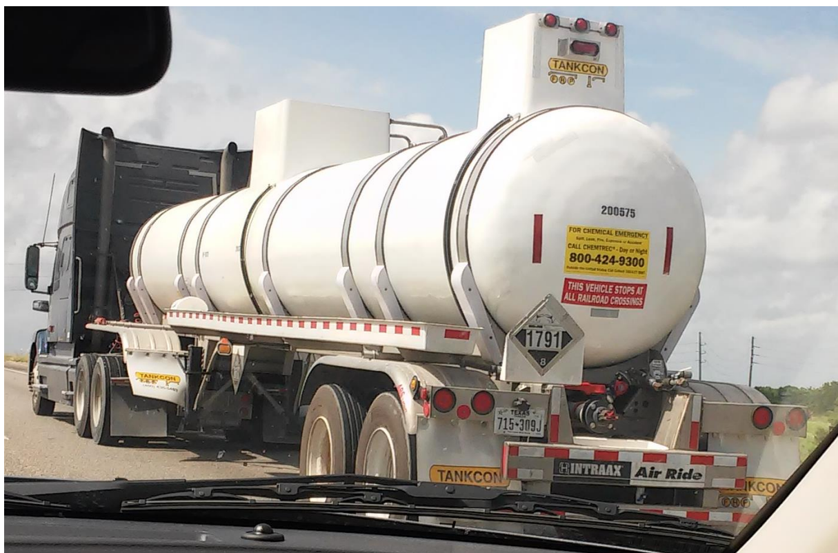
13. kép. Az UN-szám láthatósága a szállítóeszközön. Forrás: Saját fénykép.
