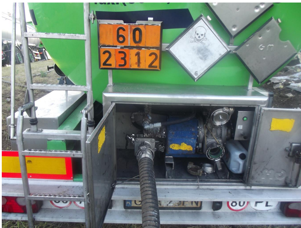
12. kép. Az osztott, számozott narancssárga tábla tartalmazza a szállított anyagra vonatkozó legrészletesebb információt. Forrás: saját fénykép.
