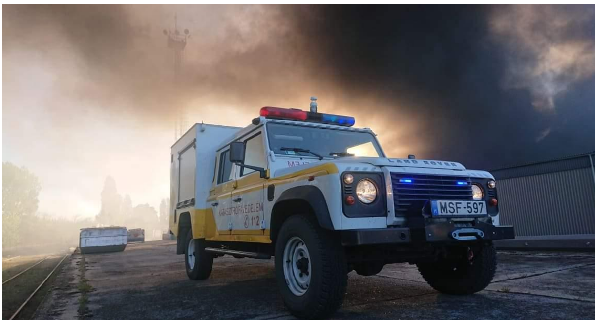
11. kép. A Katasztrófavédelmi Mobil Labor, mozgó felderítési módban. A kép forrása: saját fénykép.
