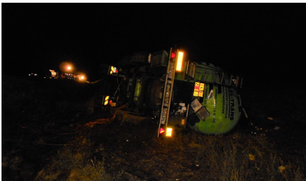
10. kép. Az osztott, számozott narancssárga táblákat a szállítóeszköz elején és hátráján helyezték el, a számozás: 60/2312. A kép forrása: saját fénykép.
