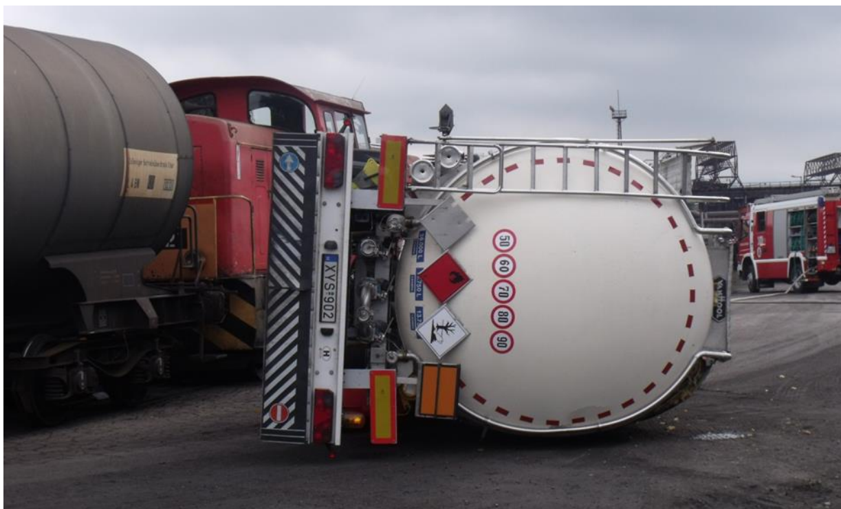
9. kép. Az osztott, számozott narancssárga táblákat az oldalakon helyezték el, a számozás: 33/3295. A kép forrása: BM OKF.
