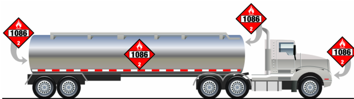
35. ábra. Az UN-szám láthatósága a szállítóeszközön, a 49 CFR alapján [146].
