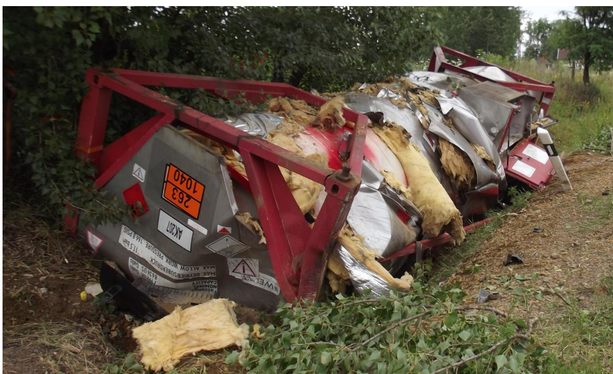
19. kép. A sérült, de nem szivárgó tankkonténer a vontató és a félpótkocsi eltávolítása után. Forrás: BM OKF.
