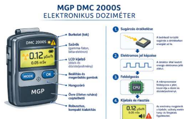
31. ábra: MGP DMC 2000s doziméter működése (forrás: a szerző szerkesztése)
