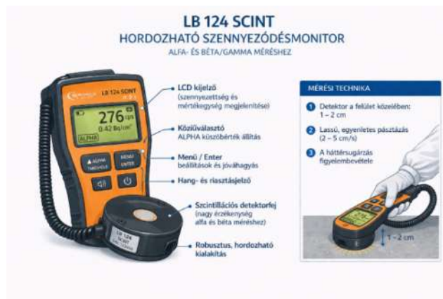
32. ábra: LB 124 SCINT hordozható szennyeződésmonitor működése (forrás: a szerző szerkesztése)
