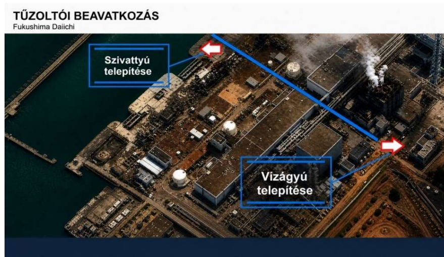
17. ábra: Kijelölt vízszervezési és telepítési helyek Fukusimában (forrás: szerkesztette a szerző [65] alapján)
