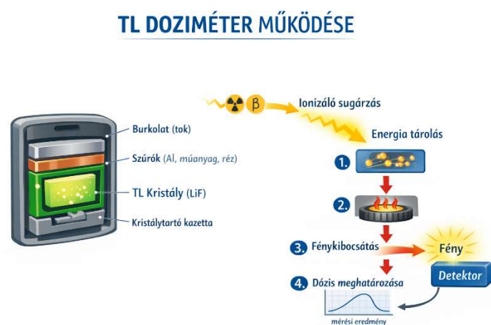
30. ábra: TL doziméter működése (forrás: a szerző szerkesztése)
