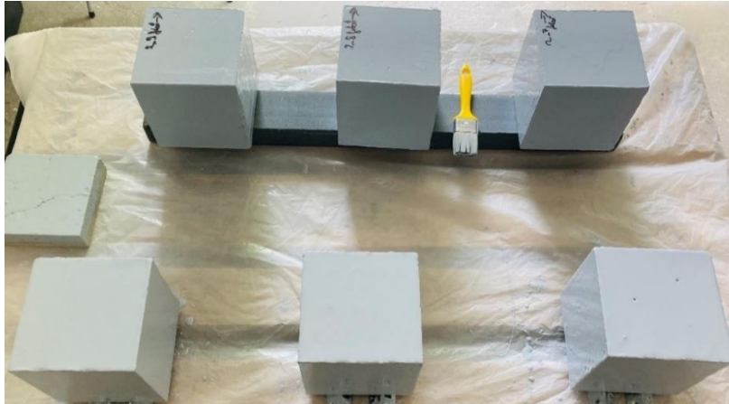
43. ábra: Próbakockák az első, illetve a második epoxigyanta réteg felvitele után Forrás: saját fénykép
