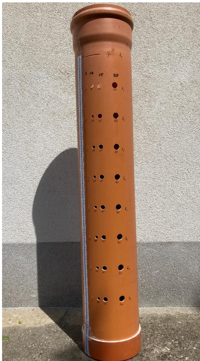
24. ábra: A kísérlethez készített cső a mércével és a sérülést reprezentáló lyukak
