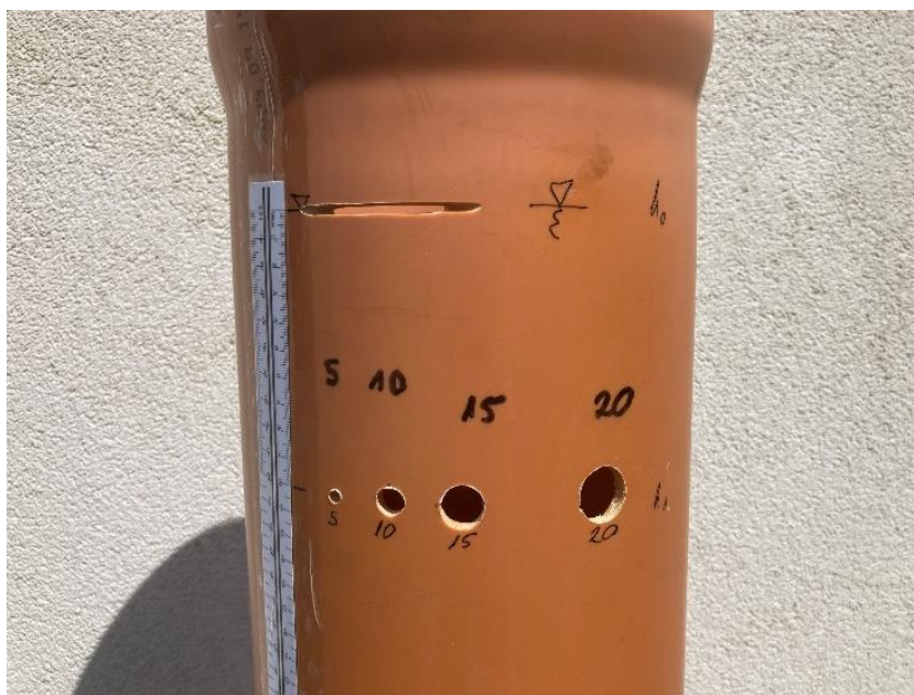
23. ábra: A kísérlethez készített cső és a túlfolyó
