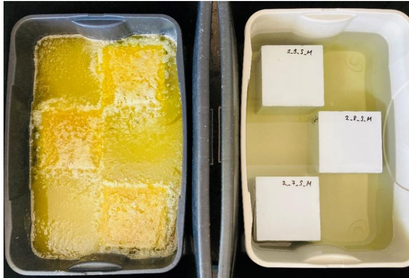
45. ábra: Próbakockák a 72 óra kitéti idő leteltét követően
