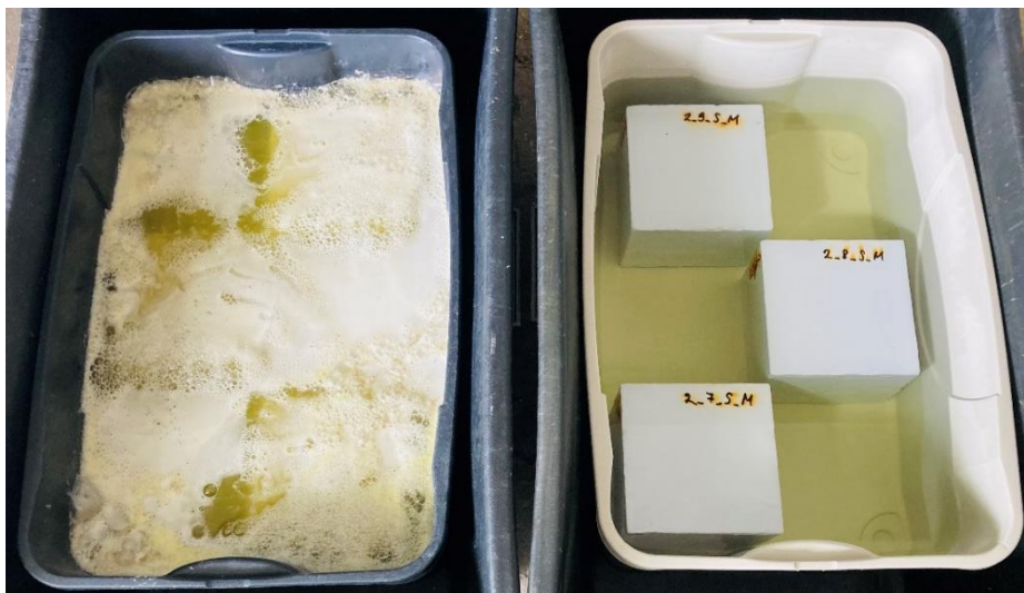
44. ábra: Próbakockák közvetlenül a 20%-os sósavba helyezésüket követően (bal oldal: bevonat nélküli; jobb oldal: bevonatolt) Forrás: saját fénykép
