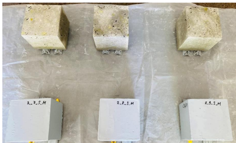
46. ábra: Próbakockák a tisztítást és szárítószekrényben történő szárítást követően
