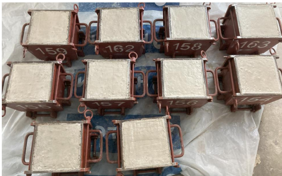
41. ábra: Második turnus próbakockái a bezsaluzást követően
