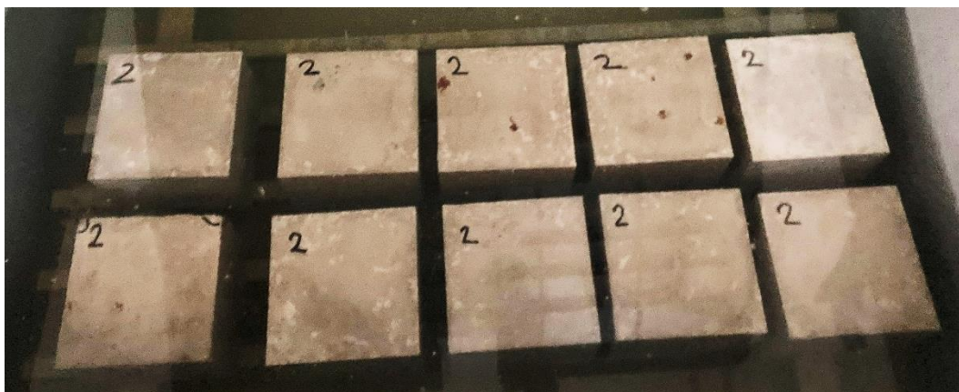
42. ábra: A próbakockák vízzel töltött utókezelőtartályban történő tárolása
