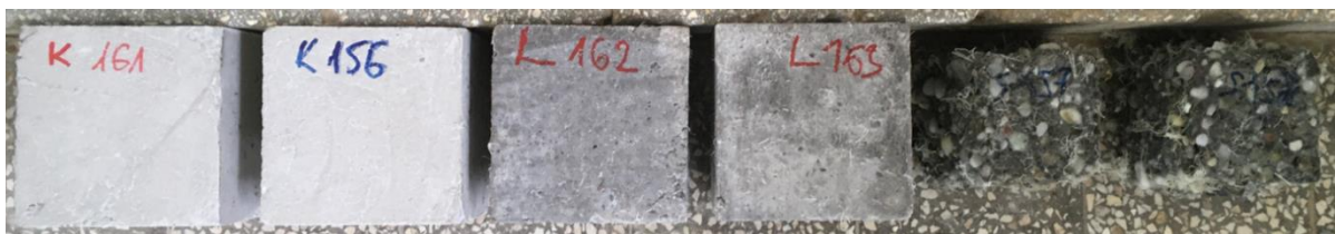
38. ábra: A próbakockák 3 napos áztatás után (balról jobbra: 2 db labor levegőn tárolt kontroll próbatest, 2 db NaOH 50%-ban ázott próbatest és 2 db HCl 30%-ban ázott próbatest)
