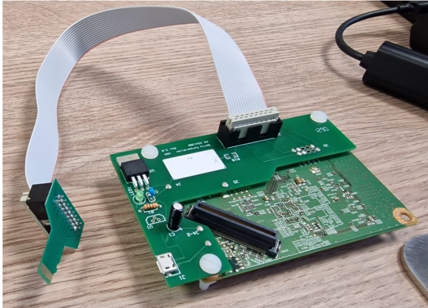
45. ábra Bench-top adatkinyerés esetén a járműből kiszertelt fejegység nyomtatott áramköri lapjához csatlakoztatott modul segítségével csatlakoztatható az adattároló a szakértői számítógéphez.
