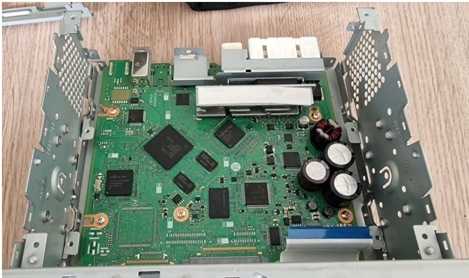
44. ábra Jármű fejegység nyomtatott áramköri lapján találhatóak a releváns adatokat tároló integrált áramkörök
