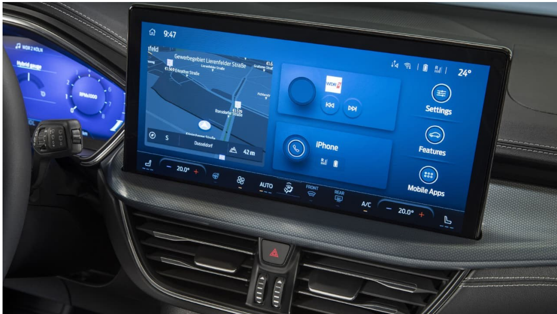
36. ábra Járő multimédiás fejegység, az egyik leggazdagabb adatforrást biztosító elem a szakértői vizsgálatokhoz [146]
