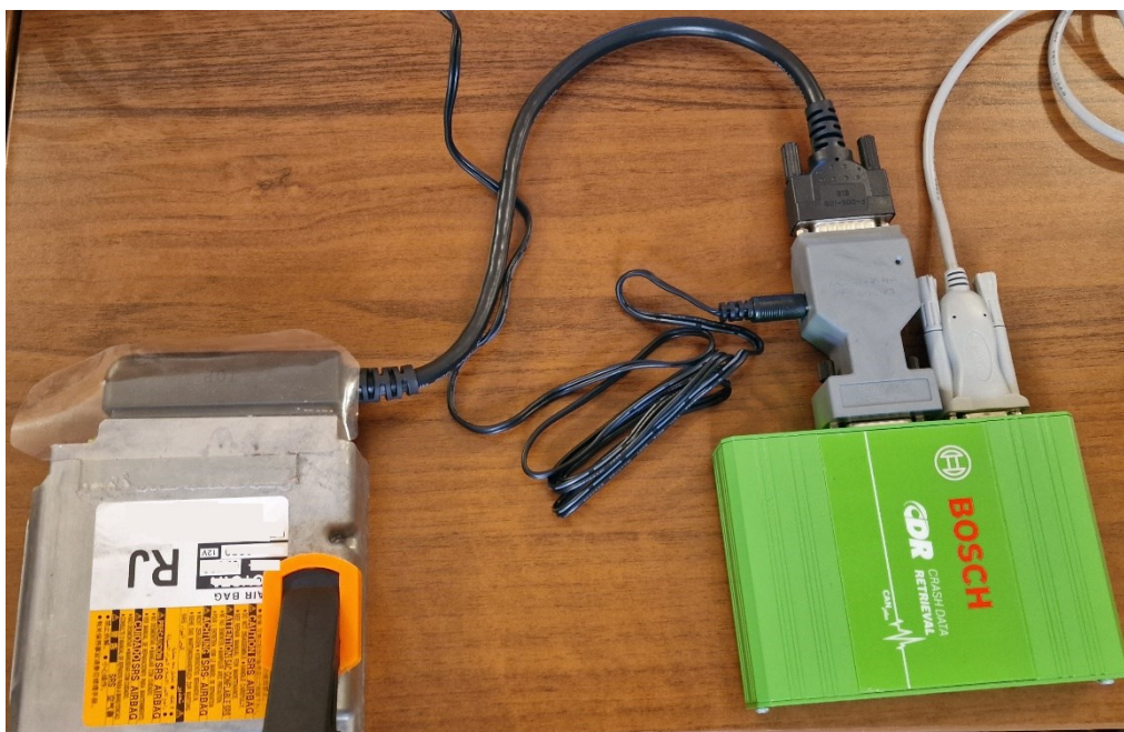
40. ábra Légzsákvezérlő csatlakoztatási módja CDR olvasóhoz
