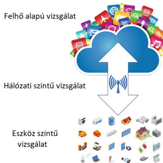
24. ábra Az IoT szakértői vizsgálat három szintje (A szerző szerkesztése [154] alapján)
