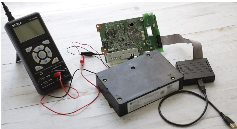
28. ábra Járműből kiszertelt központi egység vizsgálati eszközei Forrás: a szerző felvétele
