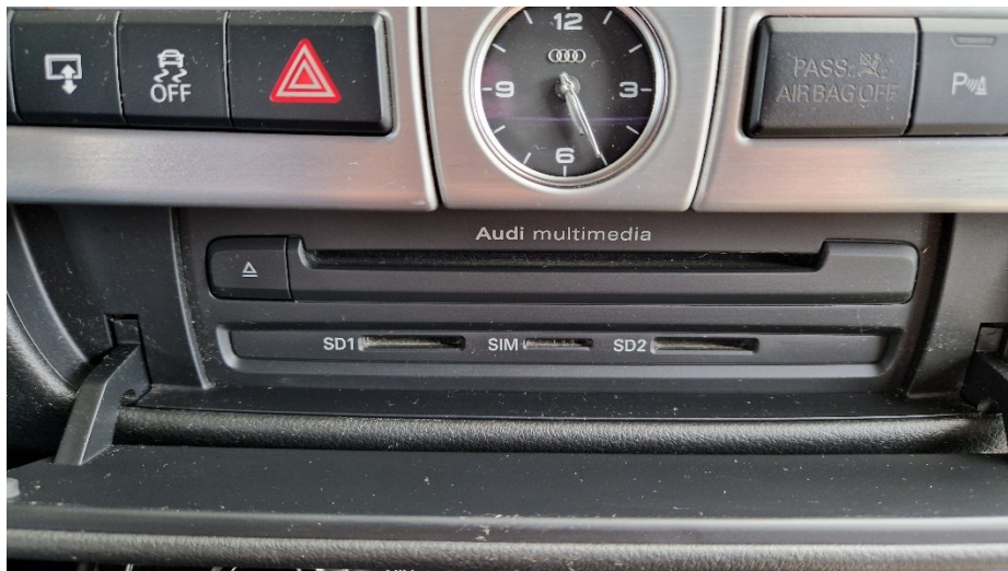
32. ábra Jármű multimédia egység USB és SIM csatlakozási lehetőséggel
