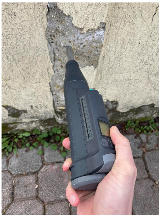
30. ábra A vizsgálatomhoz használt N-jelű Schmidt kalapács (készítette: a szerző)
