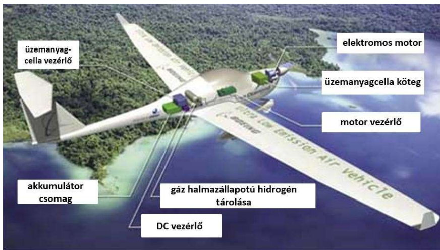
34. ábra Diamond HK36 Super Dimona meghajtásának főbb részei [110]
