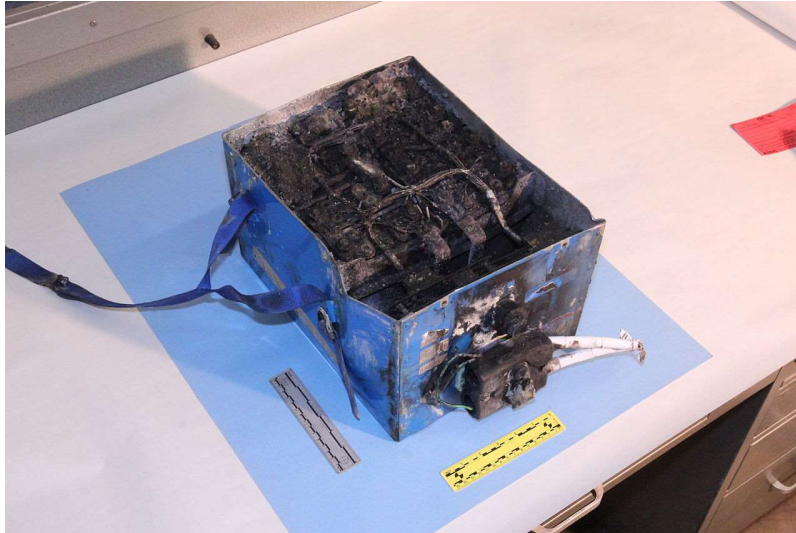
51. ábra A Japan Airlines egyik Boeing 787-sének kiégett APU 23 akkumulátora [144]
