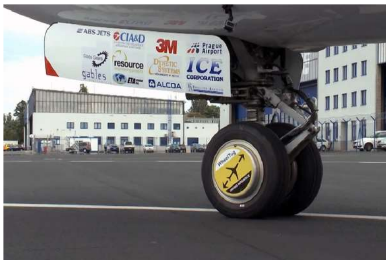
71. ábra WheelTug rendszer elhelyezése az orrfutóművön [179]
