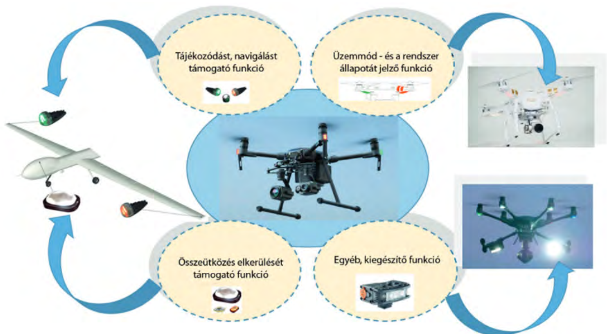
46. ábra Drónok fedélzeti világításainak funkció szerinti csoportosítása (készítette a szerző a [S8] alapján)
