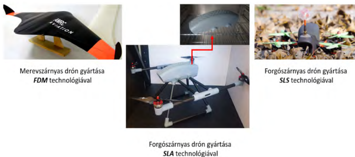
13. ábra FDM-SLA-SLS technológiával készült drónok (készítette a szerző a [56][57][58] alapján)
