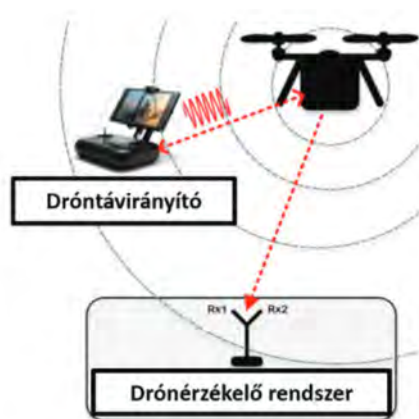
38. ábra Drón által sugárzott rádiójel érzékelésének modellje (készítette a szerző az [S5] alapján)
