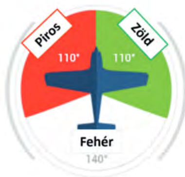
45. ábra Repülőgépek helyzetjelző-és villogó fényeinek szögtartománybéli lefedettsége (készítette a szerző az [S8] alapján)
