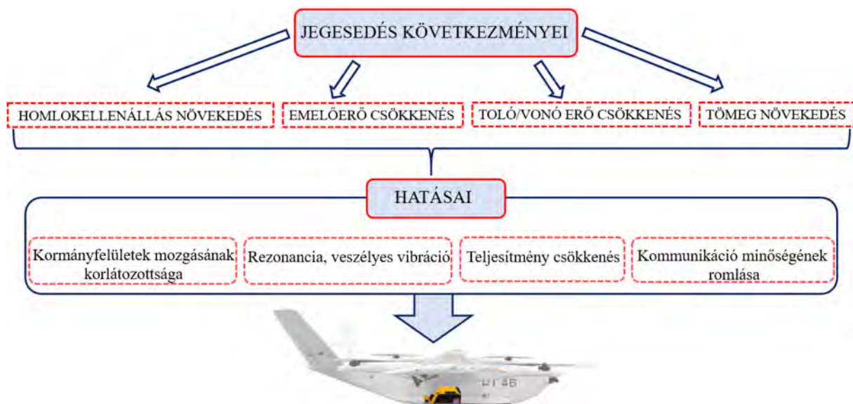
18. ábra Jegesedés kialakulásának következményei és annak hatásai (készítette a szerző a [9] alapján)
