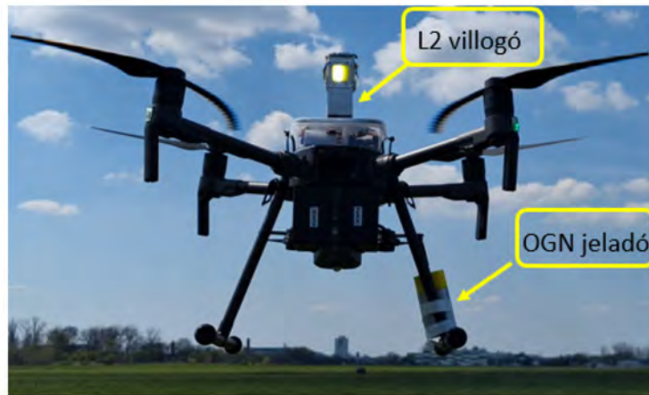
55. ábra M3 mérésnél használt DJI 210M drón, fedélzetén OGN jeladó és L2 LED villogó (készítette a szerző)
