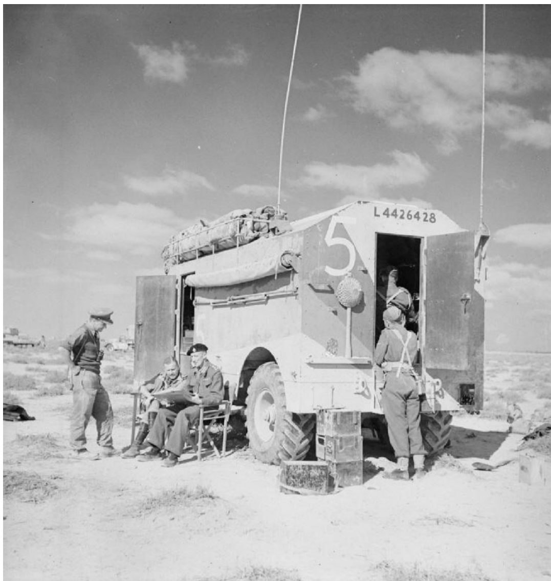
3. kép Járműfelépítménybe telepített brit MVP, a II. világháború észak-afrikai hadszínterén (Forrás: [57])
