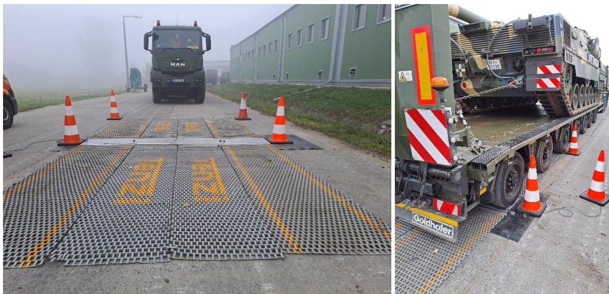
40. ábra: A Magyar Közút Nonprofit Zrt. mobil tengelysúlymérő szőnyege mérésre előkészítve a tatai laktanyában (balra) és a megrakott tréler leghátsó tengelyének mérlegelése (jobbra) 330
