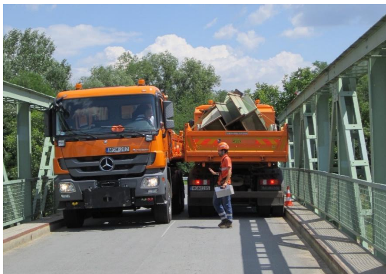
22. ábra: A 2. sz. teherállás, két 31 tonnás, háromtengelyes teherautóval 262
