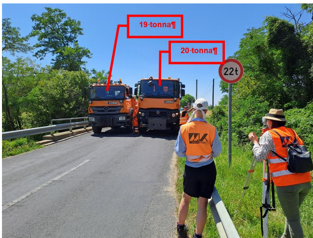
28. ábra: Híd próbaterhelés eredményeként felülvizsgált, bevonható korlátozás 275
