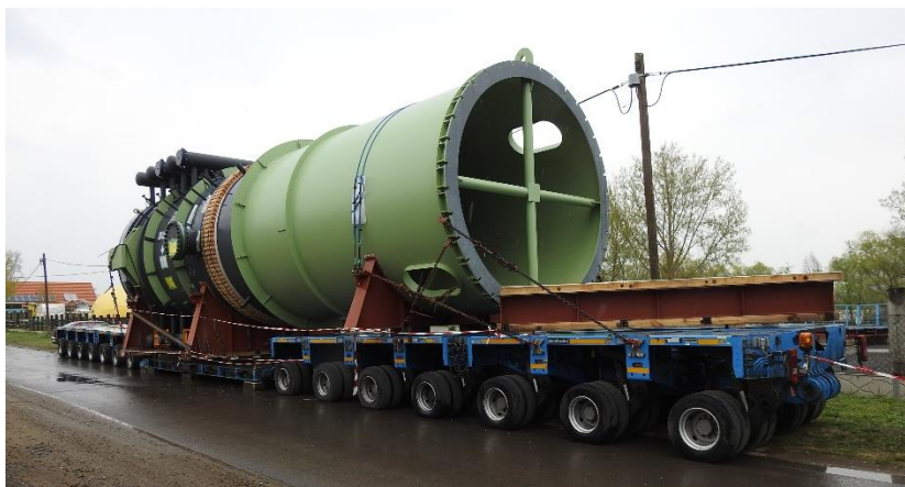
24. ábra: 250 tonna össztömegű szerelvény közel 16 tonna tengelyterheléssel 265
