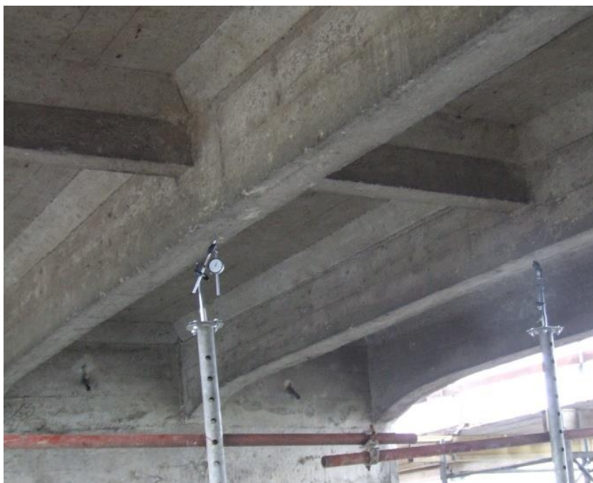
21. ábra: Mechanikus mérőórákkal mértem a vasbeton főtartó bordák lehajlását 260
