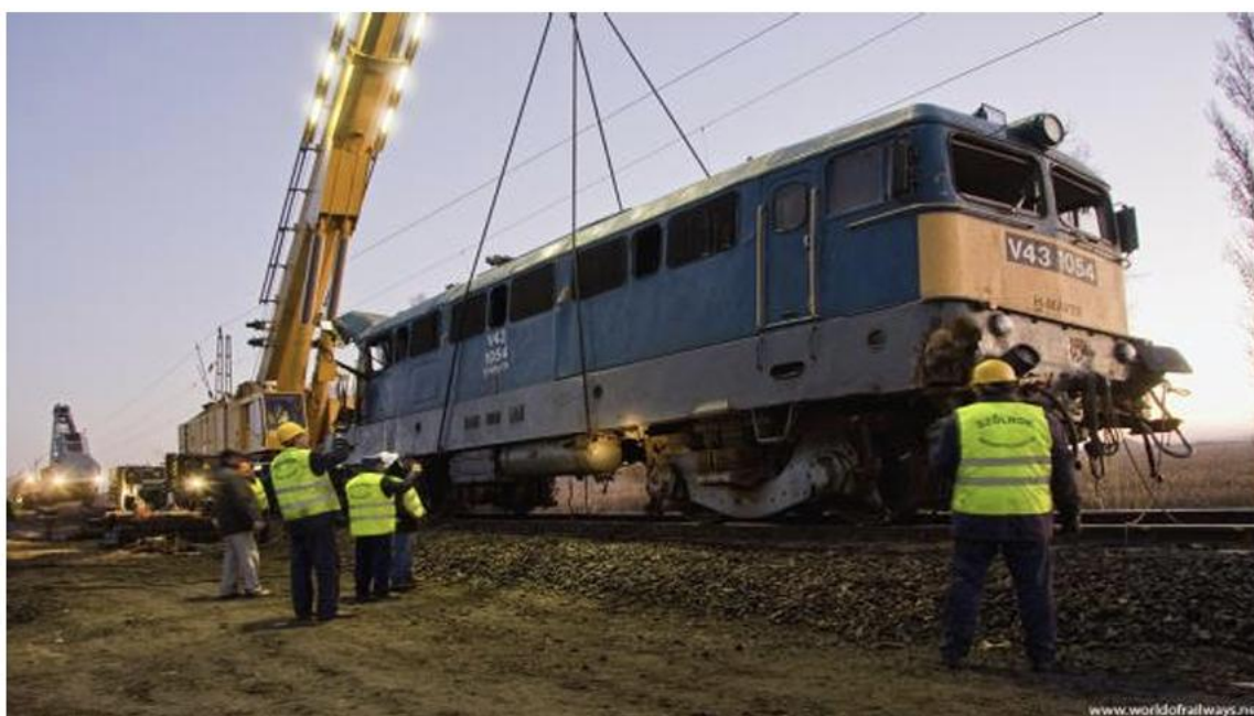
13. ábra: Műszaki mentés, KRC 1220 típusú Kirov daru [74]
