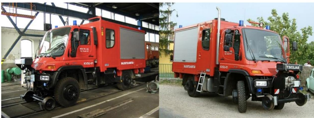
12. ábra: MÁV KVSU-01 jelű Mercedes Unimog típusú közúti-vasúti balesetelhárító jármű [74]
