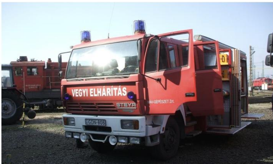
14. ábra: A Vasúti Vegyi Elhárító Szolgálat STEYR 13S23/P46 típusú vegyi elhárító gépjármű [78]
