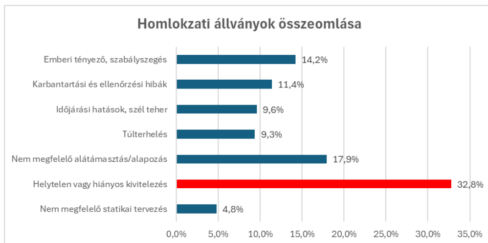
7. ábra: Az állványok összeomlásának okai. Forrás: [64]
