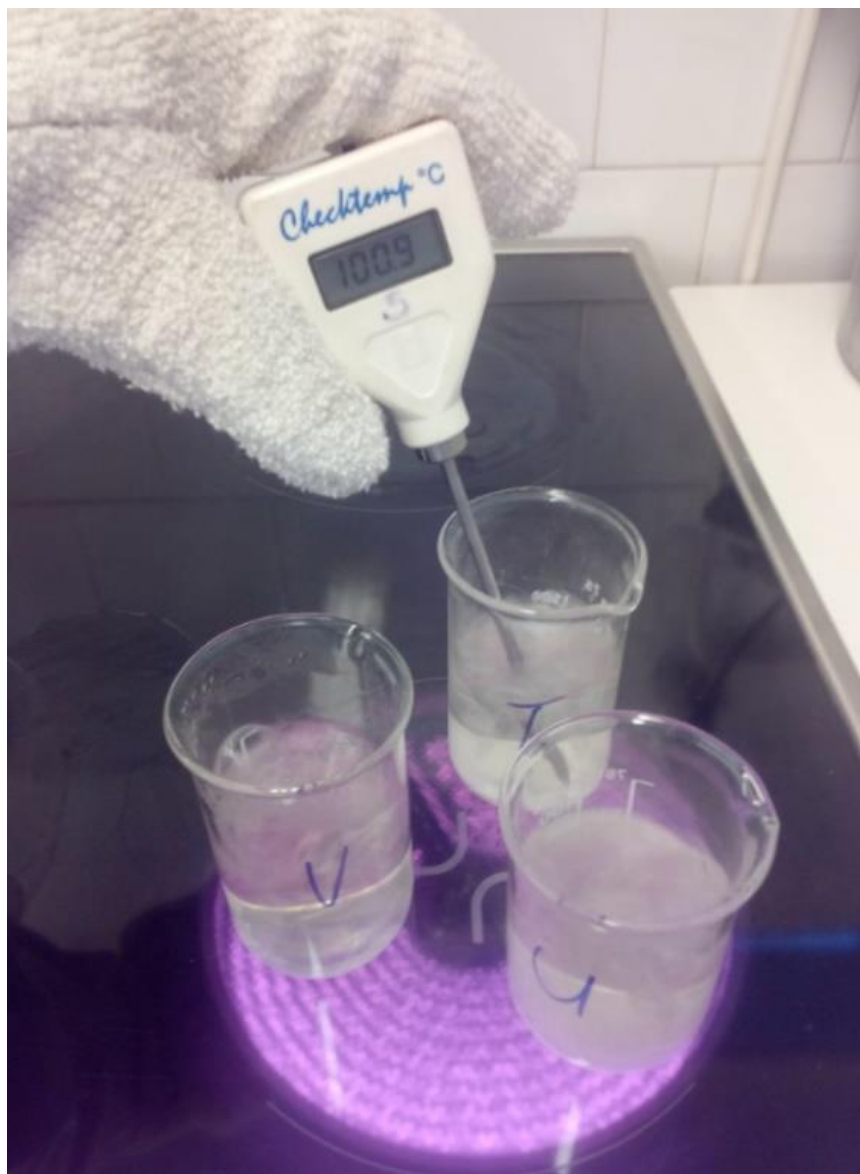
4. kép: Vízminták forralása, valamint a forráspont mérése. Készítette: Szerző.
