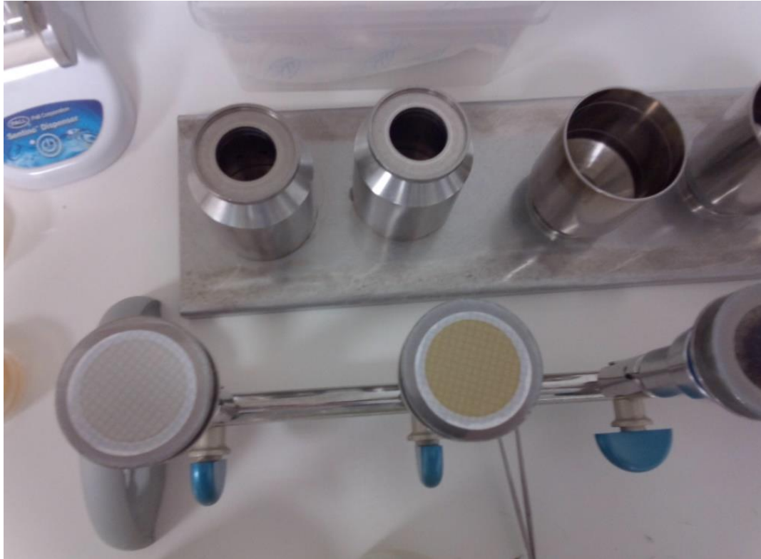
2. kép: A vízminták szűrése Sartorius szűrővel. A képen 100 ml szűrt vízminta utáni szűrőpapír látható, melyet a táptalajra helyeztem csipesszel. Készítette: Szerző.
