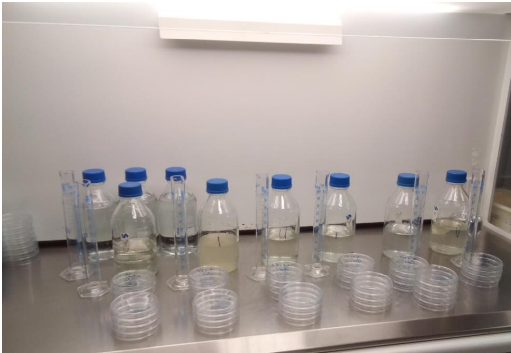
1. kép: Vízminták előkészítése az összcsíraszám meghatározásához. Készítette: Szerző.
