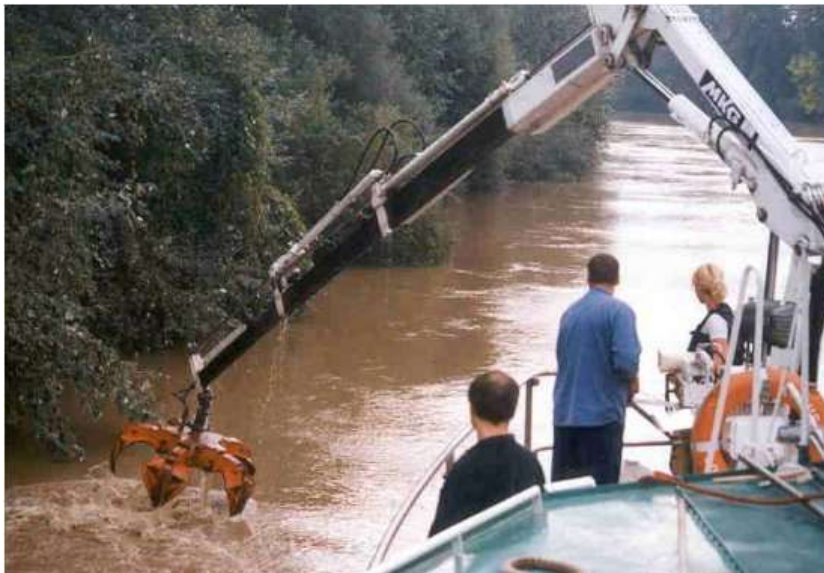
33. ábra Az üledék felszínéről történő mintavétel polipmarkolóval [99]
