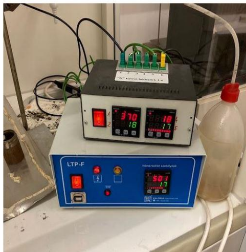
24. ábra: A DCM csepegtetés lángthatás mellett 370 °C –on. Készítette: A szerző.
