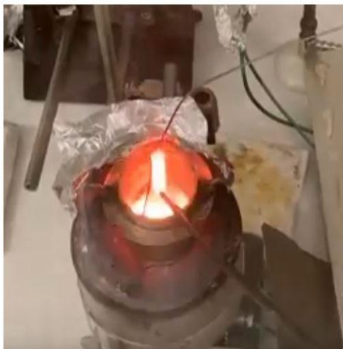
24. ábra: A DCM csepegtetés lángthatás mellett 370 °C –on. Készítette: A szerző.
