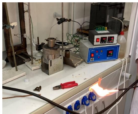
21. ábra: Vizsgálati eljárás láng nélkül (bal) és láng segítségével (jobb). Készítette: A szerző.
