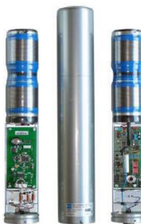
2. kép: Gamma dózisteljesítmény mérésére szolgáló BITT detektor szerkesztette a szerző, forrás: szerző
