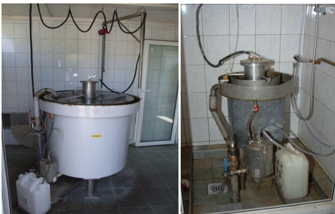
3. kép: Vízmintavételre és mérésre szolgáló V-típusú állomások. Baloldalon a 400 literes (V1-, V2 típusú), jobb oldalon 30 literes (V3 típusú), szerkesztette a szerző, forrás: szerző
