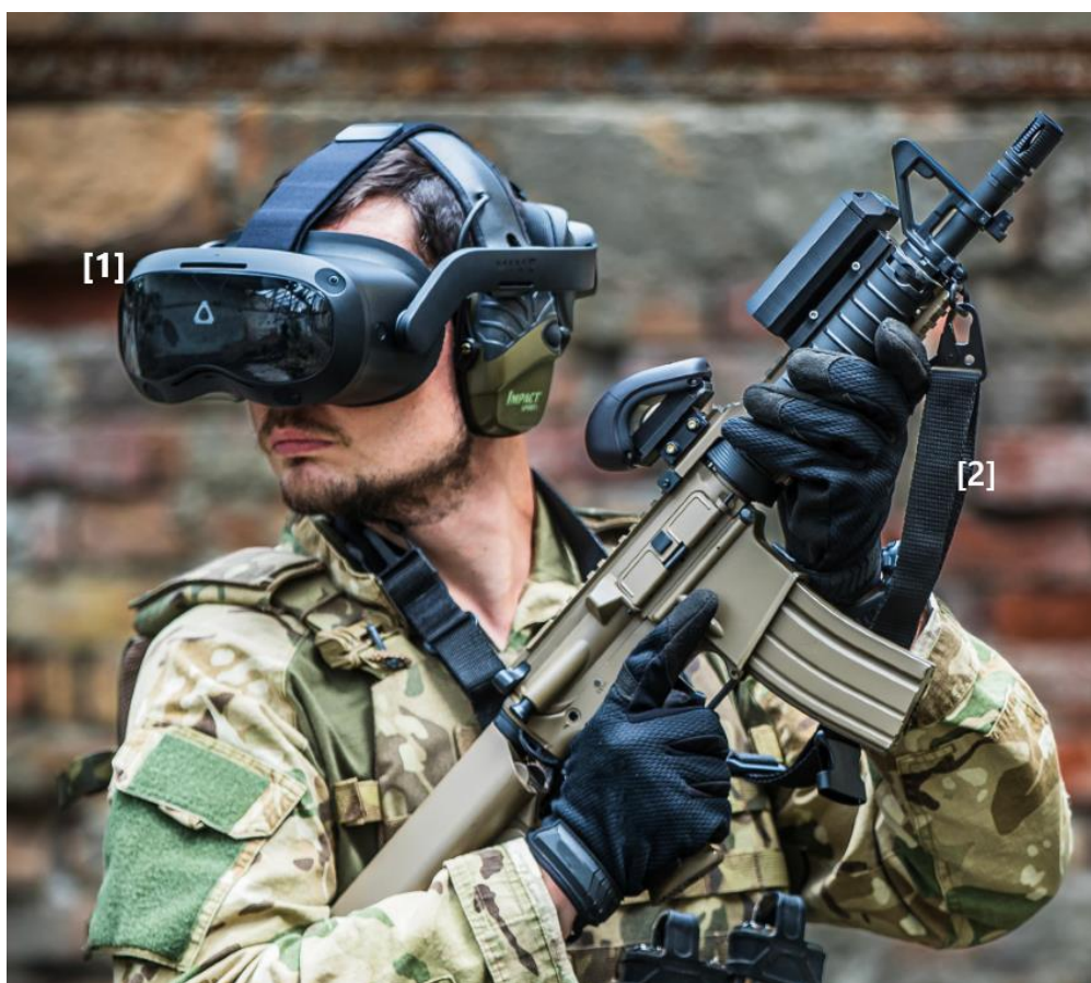
27. ábra A GTS VR taktikai szimulációs rendszer „hordható” személyi felszerelésének részei [1] HMD, [2] instrumentált fegyver Fotó: Pápai Joci Phtoto, a szerkesztés a szerző munkája.
