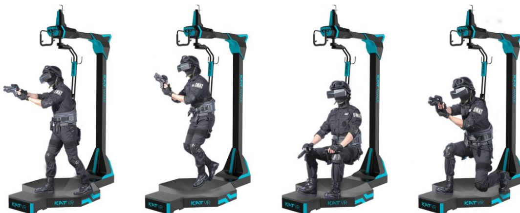
20. ábra Virtuális „taposómalom” (ODT) a helyváltoztatás digitalizálásához alkalmazható 32
