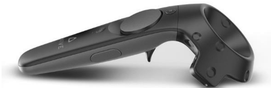
19. ábra A HTC Vive Pro Controller – a kéz mozgásait digitalizáló eszköz. A gömbölyített fejrészen megfigyelhetők az optikai követést lehetővé tévő infravörös LED-ek bemélyedései, illetve a száron lévő érintőfelület (touchpad) 30
