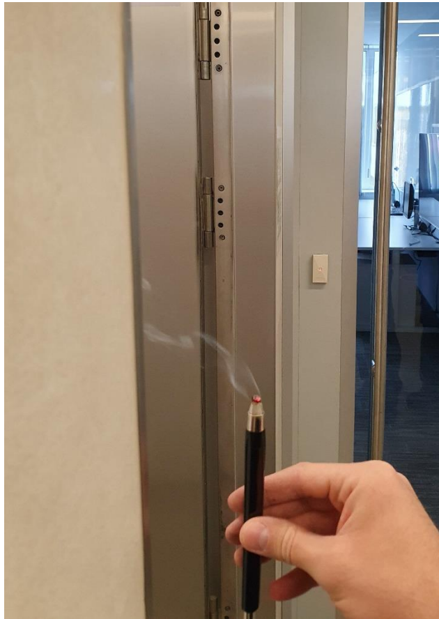
2. kép – Áramlás vizsgálata „smoke pen” használatával, készítette a szerző [86]
