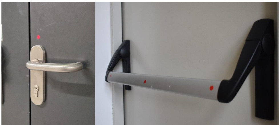
13. kép – A mérési pontok jelölése kilinccses és pánikrudas ajtón, készítette a szerző
