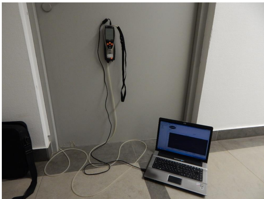
1. kép – Nyomáskülönbség mérés és regisztrálás csukott lépcsőházi ajtón keresztül, szerző felvétele
