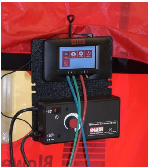
6. kép – DG-1000 digitális nyomás- és áramlásmérő felszerelt állapotban, készítette a szerző
