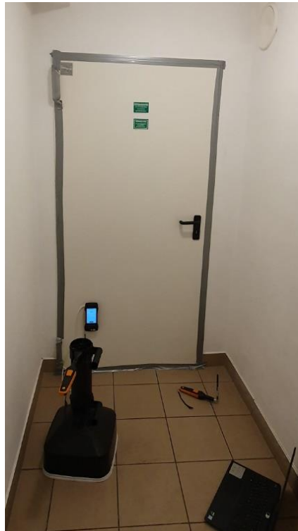
8. kép – Mérésre előkészített ajtó a lineáris rések leragasztott állapotában, készítette a szerző
