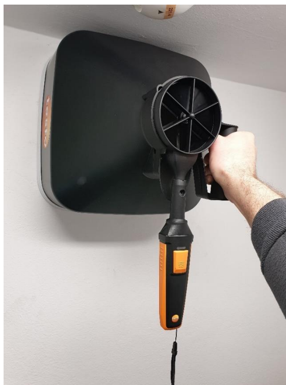
5. kép – A levegő mennyiségének mérése mérőtölcsérrel és szárnykerekkes szondával, készítette a szerző [133]
