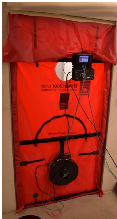
3. kép – Az ajtókeretbe szerelt blower door műszer a mérés közben, készítette a szerző
