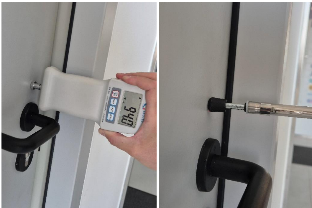
12. kép – Nyitási erő mérése kalibrált digitális húzó-nyomó erőmérő alkalmazásával és egyszerű rugós erőmérővel, készítette a szerző [162]
