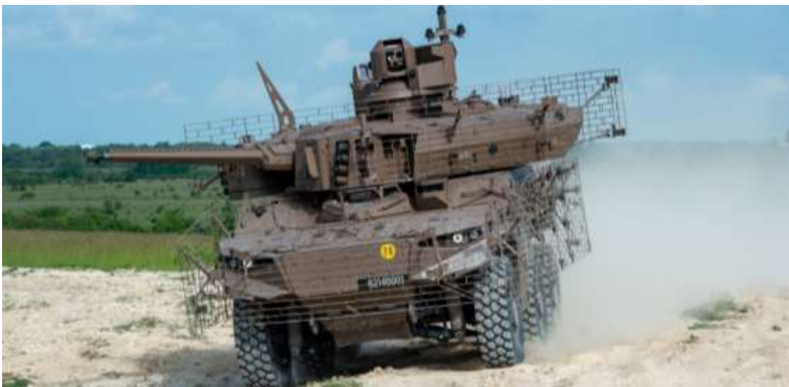
35. ábra: A francia EBRC JAGUAR páncélozott felderítő és gyalogsági harcjármű egyik RPG ráccsal felszerelt változatának tesztelése [203]
