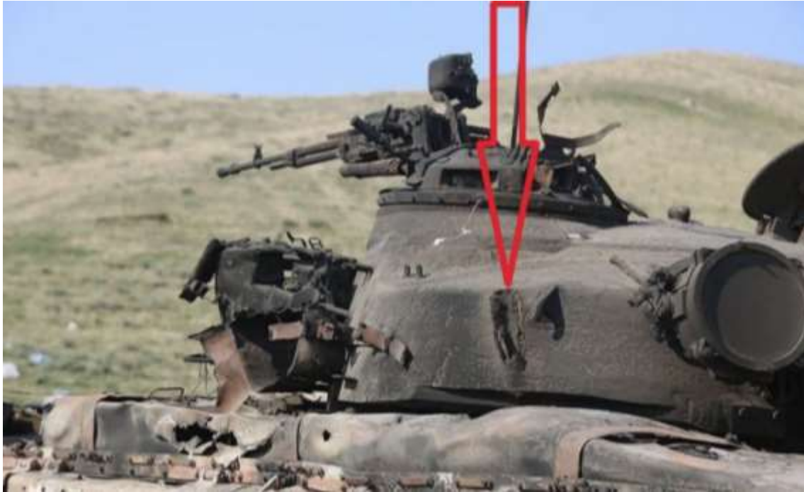
38. ábra: Egy örmény T-72B alapharcokocsiért öngyilkos dróntalálat kumulatív sugarának bemeneti nyílása [216]
