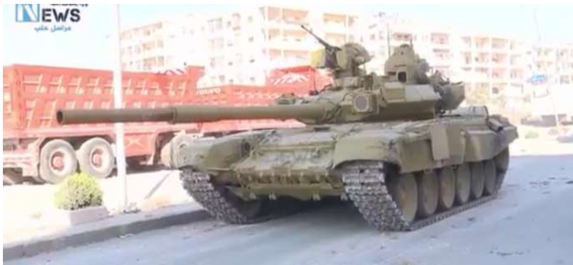
37. ábra: Egy T-90A orosz gyártású alapharcocsi a szír hadsereg állományából, reaktív és „soft-kill” 78 aktív védelmi rendszerekkel felszerelve Aleppó utcáján [31]
