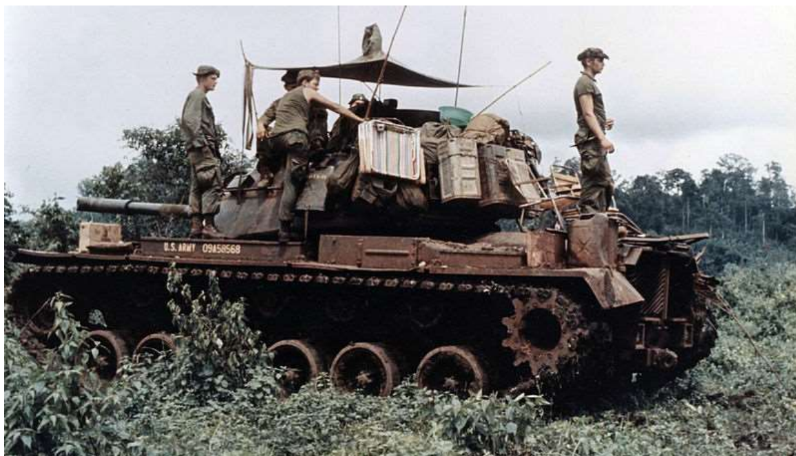
25. ábra: Egy improvizált védőelemekkel felszerelt M48 Patton harckocsi Vietnámban [168]
