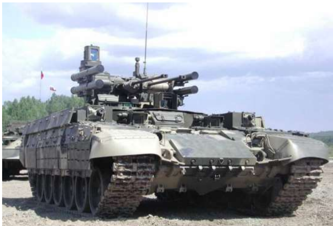
31. ábra: Egy BMPT harckocsi támogató harcjármű, amely a csecsen háborúk tapasztalatai alapján került kialakításra [186]
