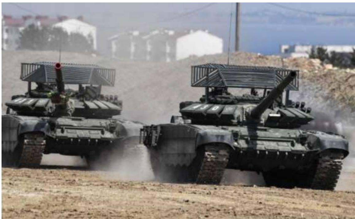
39. ábra: Az orosz T-90A típusú alapharcokcsik oszlopa az öngyilkos drónok, valamint az amerikai FGM-148 Javelin páncéltörő rakéták elleni készített improvizált „ketréccel” felszerelve [221]
