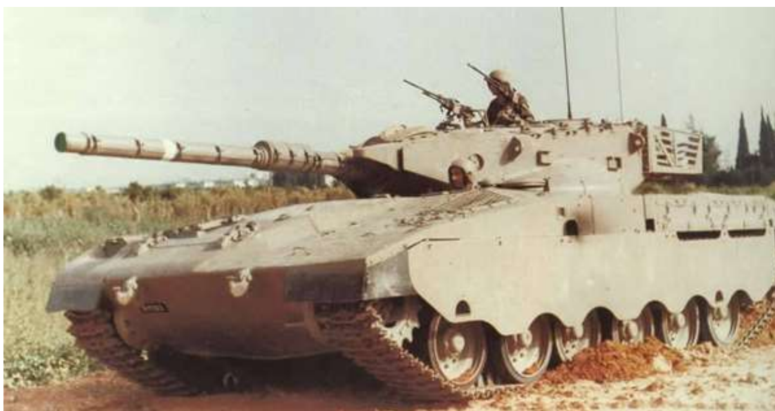
26. ábra: A Merkava Mk.1 izraeli harckocsi első, szériaérett példánya, amelyen jól látható az unortodox motor és erőátviteli rendszer elhelyezkedésére utaló mellső láncmeghajtó kerék és a meghajtomotor kipufogócső kialakítása [171]
