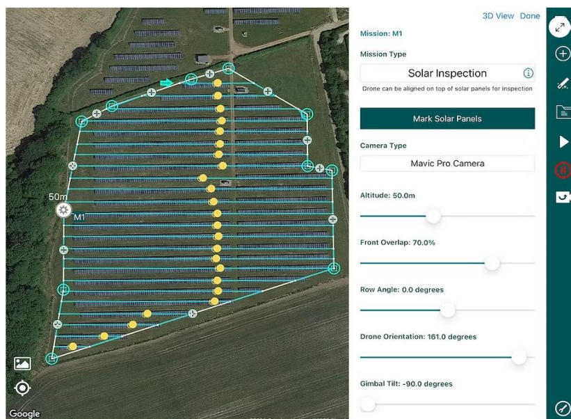
25. ábra. Útvonaltervezés kiterjedt napelempark esetén. Forrás: [107]
