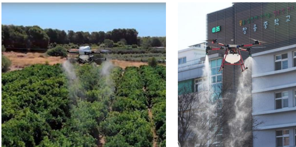
39. ábra. Permetező drón alkalmazása a mezőgazdaságban vegyszer (bal) és a pandémia alatt fertőtlenítőszer (jobb) kijuttatására. Forrás: [169,170]
