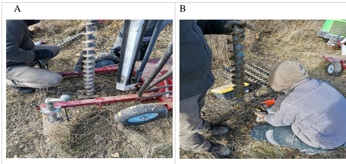
23. ábra Talajmechanikai fúrások mintavétele (készítette: a szerző)
