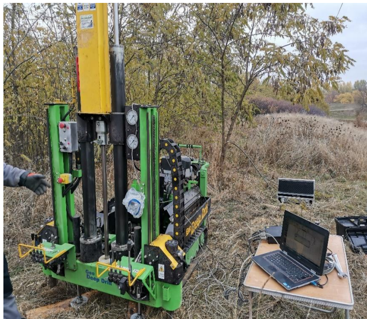
30. ábra CPT szondázások mintavétele (készítette: a szerző)
