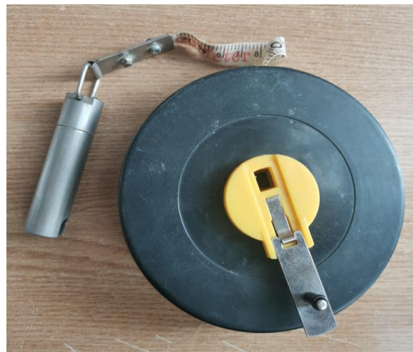
43. ábra DATAQUA DA-OP optikai kézi szintmérő (készítette: a szerző)
