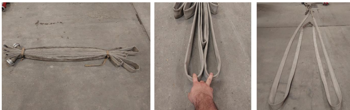
3. ábra: az öblökbe hajtogatott tömlőcsomag és széthúzása (készítette a szerző)
