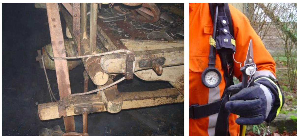
24. ábra: Tűzesetnél elakadt összegabalyodott kötélbiztosítás és légzőkészüléken tartott mentőolló (Forrás: [130])
