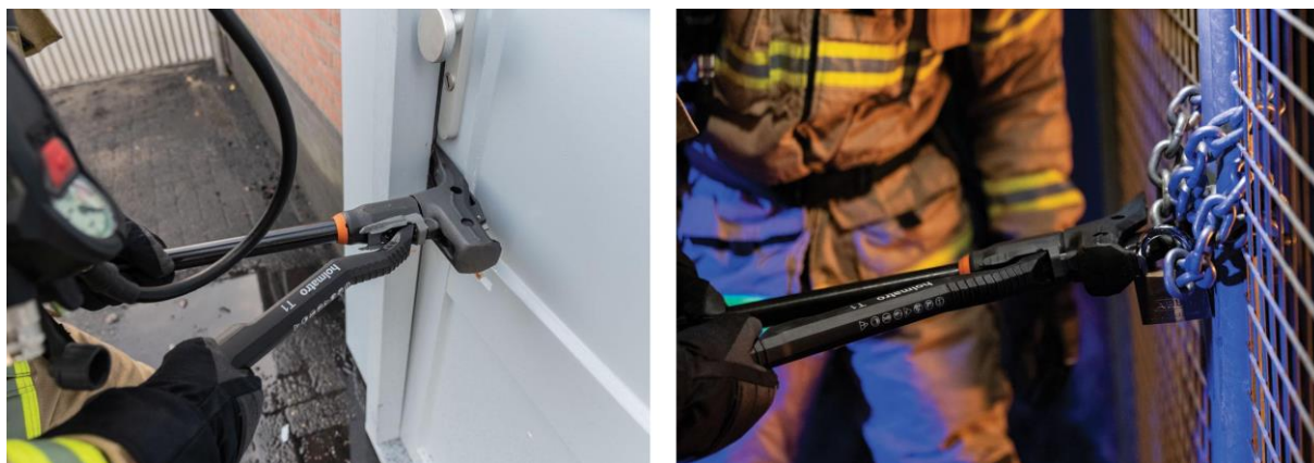
16. ábra: Holmatro T1 használata ajtó felfeszítésére és lakat levágására (Forrás: [117])
