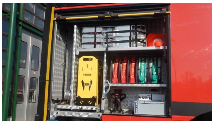
7. ábra: Tömlőszállítókosarak a HEROS Aquarex S10 vízzállító málházba (Forrás: Pántya Péter magánarchívuma)
