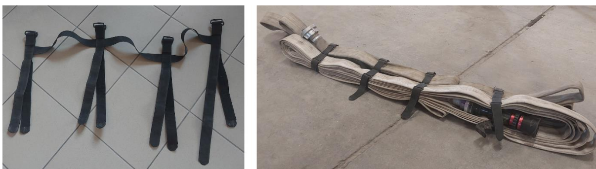
5. ábra: A hibrid tömlőcsomag hevederzete és az összekészített hibrid tömlőcsomag (készítette a szerző)
