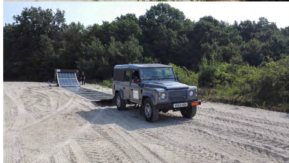
60. ábra: A brit Renowagen szolár-utánfutójának telepítése látványosan gyors (saját felvételek)
