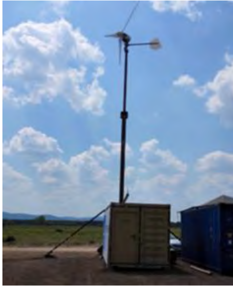
38. ábra: 2015 júniusában a Bakonyban üzemelő kísérleti szélturbina rotorátmérője 150 cm, maximális fordulatszáma 450/perc. Egy 10 méteres árbocon került elhelyezésre, amelynek stabilitásáról a szállító konténer gondoskodott (saját felvétel a CL15 gyakorlatról)
