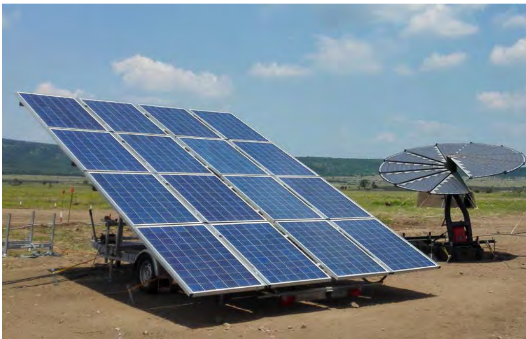
41. ábra: A kép előterében egy utánfutós mozgatású fix állásban telepíthető hagyományos napelem, a háttérben egy automatikus napkövető egység. A Smartflower virág módjára hajtogatja ki a szirmait, GPS adatok alapján állítja tájolását (saját felvétel a CL15 gyakorlatról)
