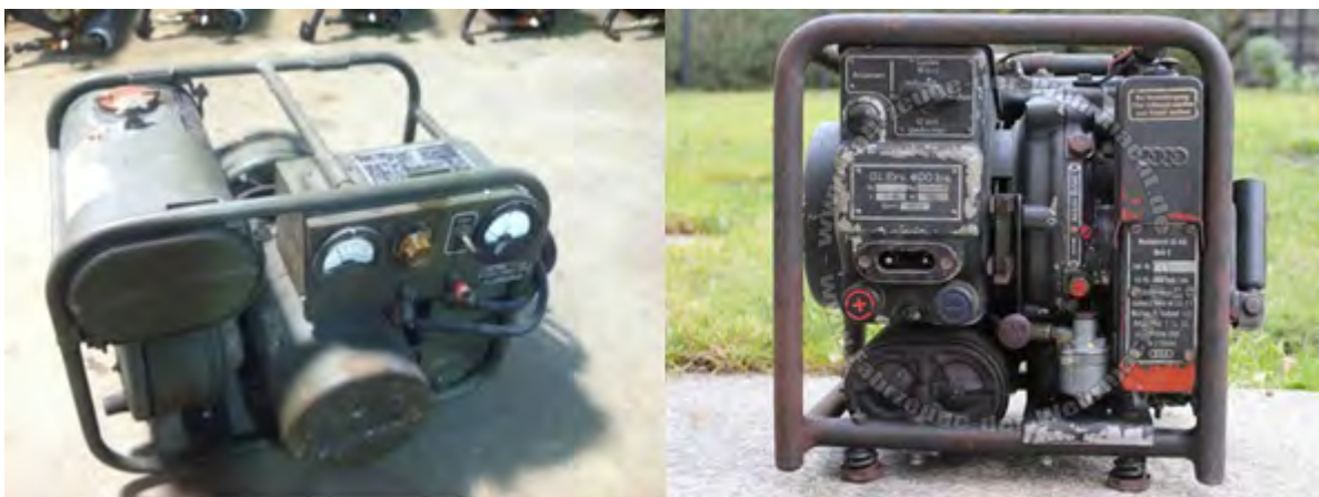
16. ábra: Amerikai General Electric 12-G és német Gleichstrom Erzeuger 400 typ B benzines aggregátorok a 2. világháborúból [74].
