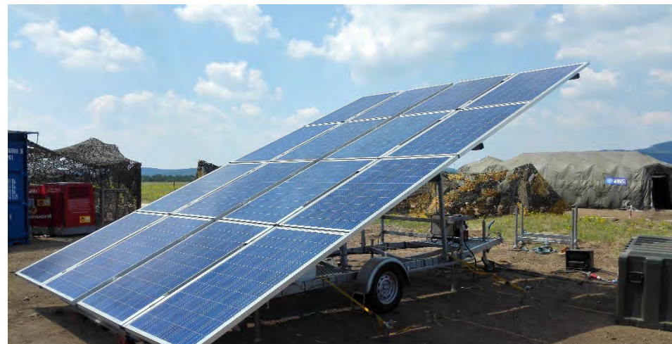
55. ábra: A Multicon szolár-utánfutója telepített állapotban (saját felvétel)
