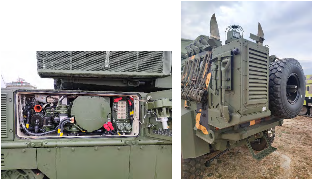
19. ábra: A Leopard 2A7 páncéltestének jobb hátsó részén található egy kis teljesítményű Steyr dízelaggregátor (ilyen nem volt még az A6-ban sem), míg a Gidránon külső függesztményként került elhelyezésre a Kubota APU (saját felvételek)
