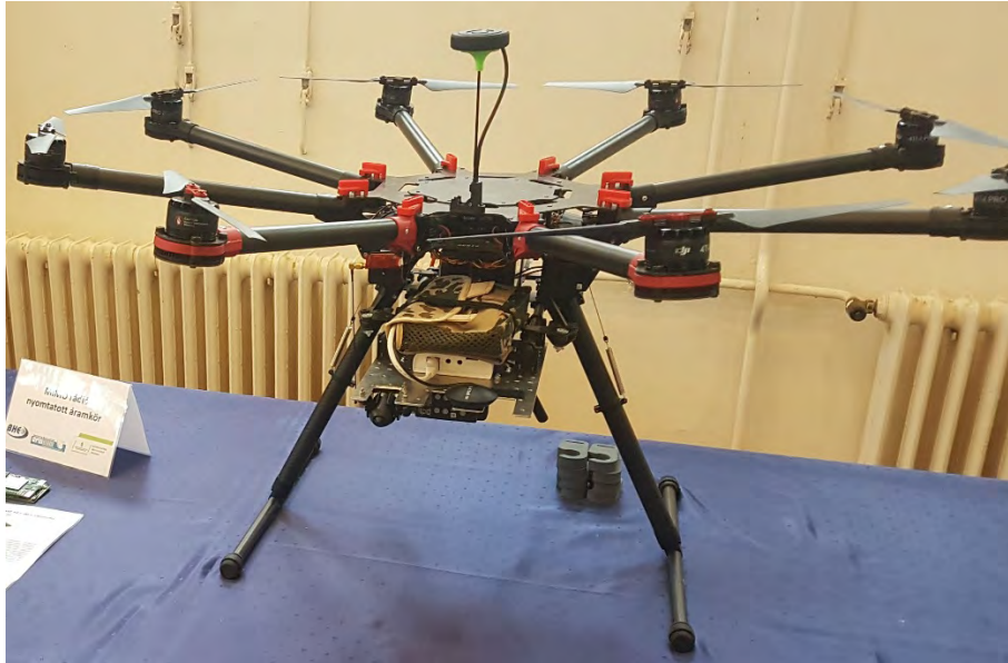
27. ábra: Magyar fejlesztésű MIMO technológiás adatrádió oktokofterre 81 szerelve, mint harctéri átjátszó, egy 2018-as bemutatón (saját felvétel)
