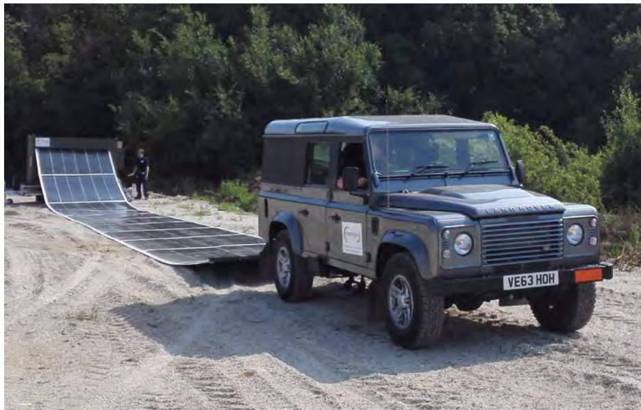
43. ábra: A „szolárszőnyeg” egy utánfutóról göngyölíthető le. A telepítéskor az utánfutót vontató terepjáró is szerephez jut (saját felvétel a CL15 gyakorlatról)
