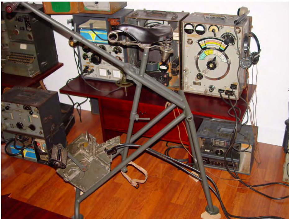
15. ábra: TM5 típusú 2. világháborús német pedál-generátor [74].
