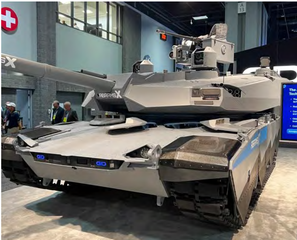
29. ábra: A hibrid hajtáslánccal szerelt AbramsX harckocsi prototípusa [122]
