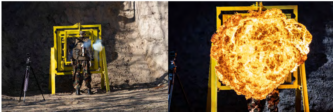
33. ábra: Az első képen a becsapódó 7,62 mm-es páncéltörő-gyújtó lövedék hatására a hidrogéngáz csak nagy nyomással távozik a palackból, míg a második képen a lövedék hatására a cseppfolyós bután be is robban (Zrínyi Média felvétele, MH Lőkísérleti Vizsgálóállomás, Táborfalva, 2023)
